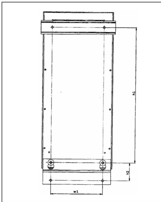
Рис. 17 Монтажные отверстия для MSF-017 ... MSF-250 (вид сзади).
