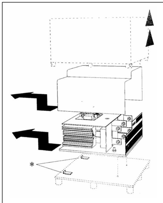
Рис. 2 Распаковка MSF-310 и больших типов
