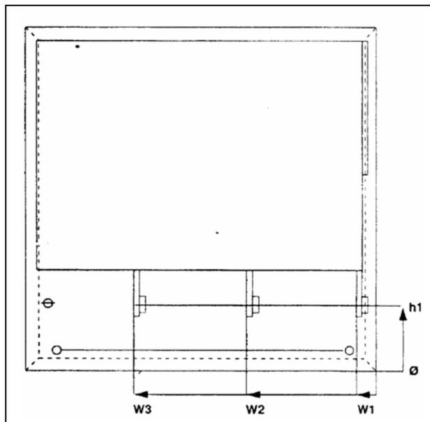
Рис. 21 Размеры шин MSF-310 ... MSF-835
