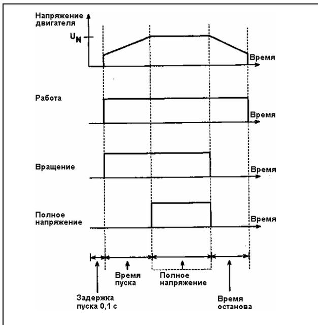
Рис. 50 Пуск/останов и функции реле "Работа" и "Полное напряжение"
