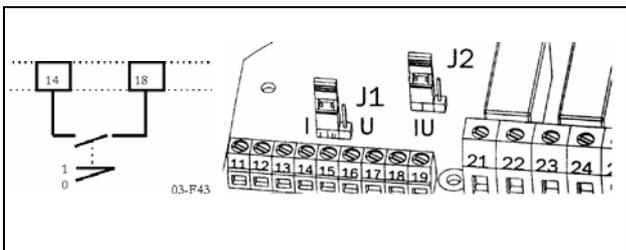
Рис. 54 Подключение внешнего сигнала управления медленной скоростью.
