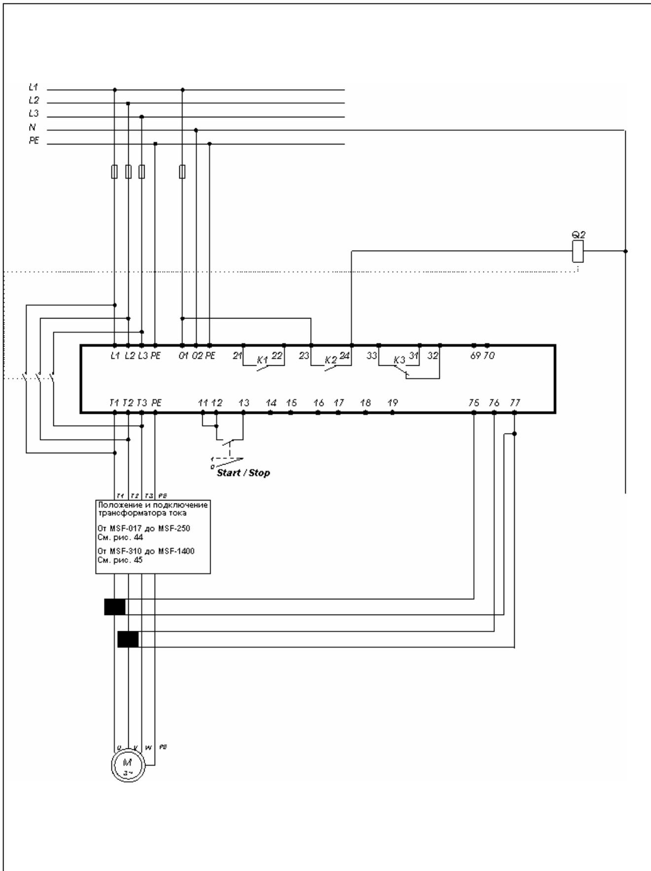
Рис. 43 Подключение с шунтированием для MSF 310-1400
