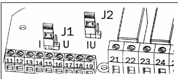
Рис. 53 Установка перемычки J1 при выборе В / мА.
