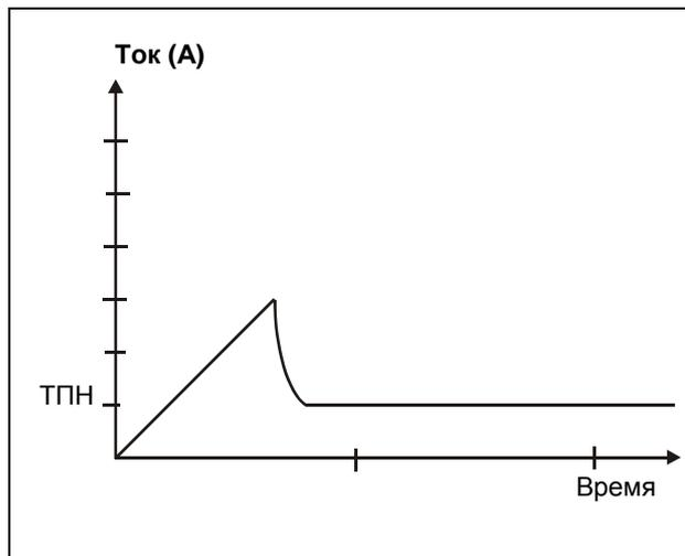
Рис. 7 График пуска при выборе управления напряжением
