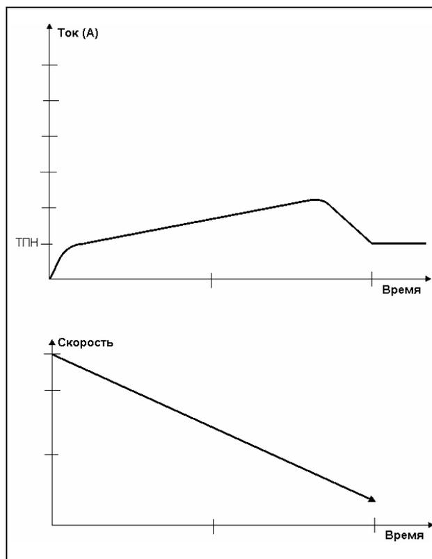
Рис. 36 Управление насосом
