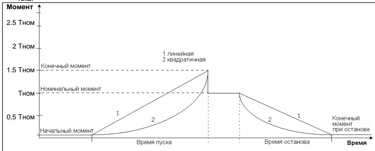
Рис. 40 Управление моментом при пуске и останове
