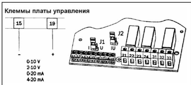
Рис. 51 Подключение аналогового выхода
