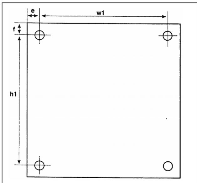
Рис. 20 Отверстия для винтов, MSF-310 ... MSF-835. Расстояния между отверстиями (мм)
