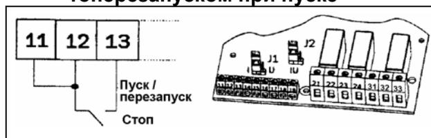
Замыкание клемм 12 и 13 на плате управления при наличии перемычки между клеммами 11 и 12 дает команду на пуск. Размыкание этих клемм дает команду на останов. Если при подаче питания клеммы 12 и 13 будут соединены, команда на пуск будет подана автоматически (автоматический пуск при подаче питания). При подаче команды на пуск происходит автоматический перезапуск.
