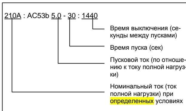
Рис. 10 Описание типоразмера по норме АС53б
