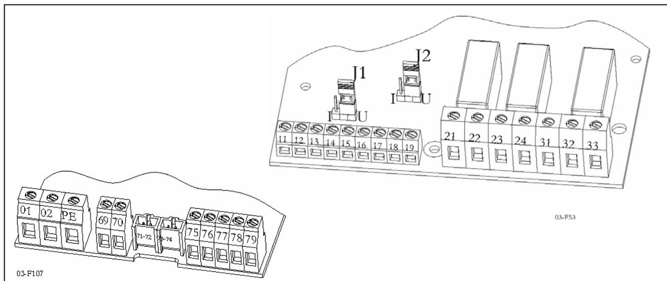
Рис. 28 Подключения на плате управления
