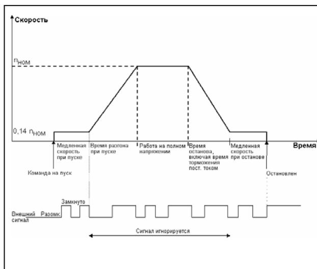
Рис. 48 Управление медленной скоростью при помощи внешнего сигнала.
