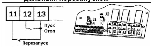
Замыкание клемм 11, 12 и 13 на плате управления дает команду на пуск, а размыкание клемм 12 и 13 дает команду на останов. Если при подаче питания клеммы 12 и 13 будут соединены, команда на пуск будет подана автоматически (автоматический пуск при подаче питания). Для подачи команды на перезапуск следует разомкнуть и вновь замкнуть клеммы 11 и 13. Команда на перезапуск может быть подана как при остановленном, так и при работающем двигателе. Она не влияет на пуск и останов.
