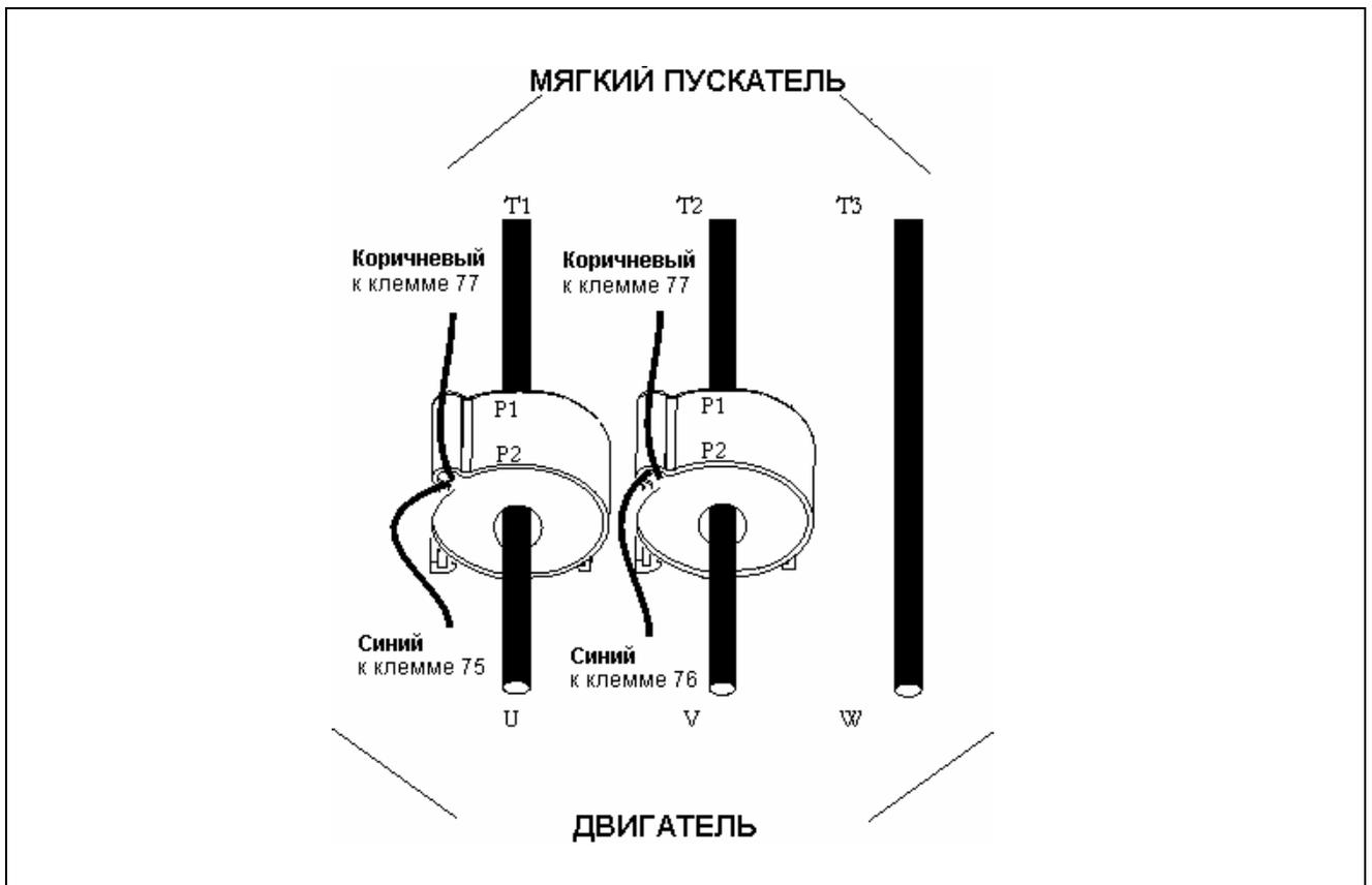
Рис. 45 Установка трансформаторов тока при шунтировании для MSF-310...MSF-1400.
