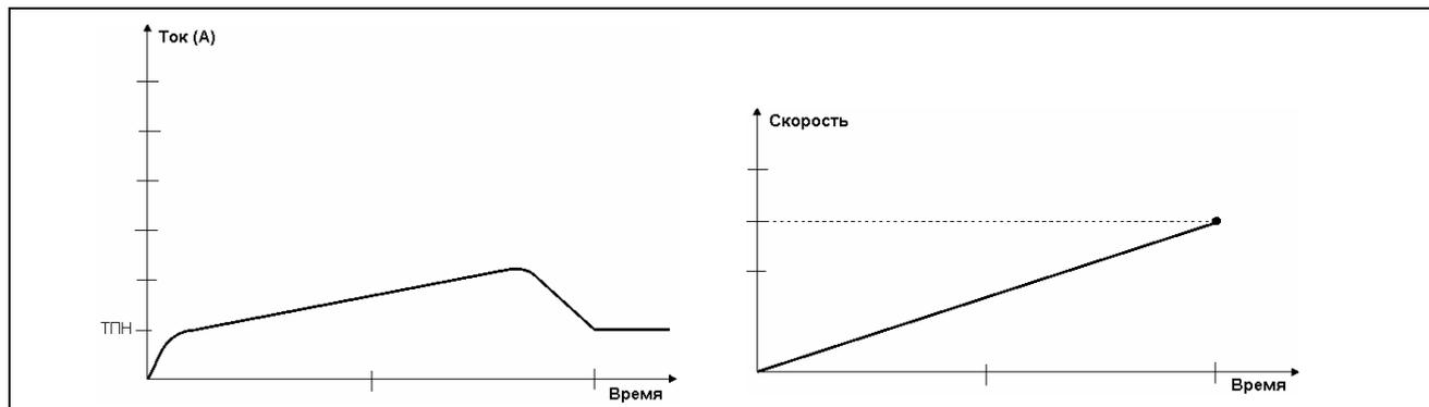
Рис. 41 Ток и скорость при управлении моментом
