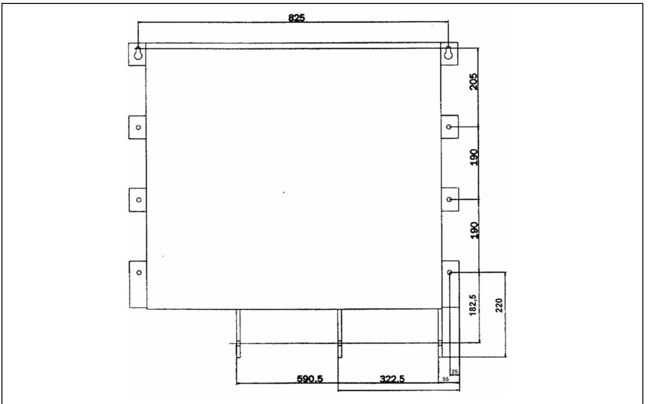
Рис. 23 Размеры отверстий для шин MSF-1000 ... MSF-1400
