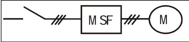
Мягкий пускатель предназначен для плавного пуска и останова трехфазных двигателей.
